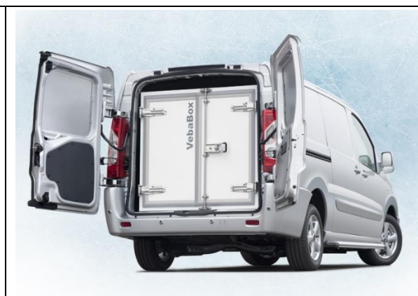
Kuva 4-19: Itsenäinen jäädytettävä tila pakettiautossa ( https://www.vebabox.com/fi/ ).
